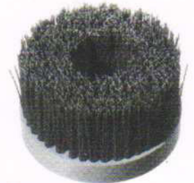
Schleifkorn-Flächenbürste Korn 60/80 Ø 120 Höhe 70 Bohrung M14 Ø 120 Höhe 70 Bohrung 14
