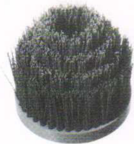
Schleifkorn-Stufenbürste 4 Segmente Korn 60/80 Ø 120 Höhe 120 Bohrung 14
